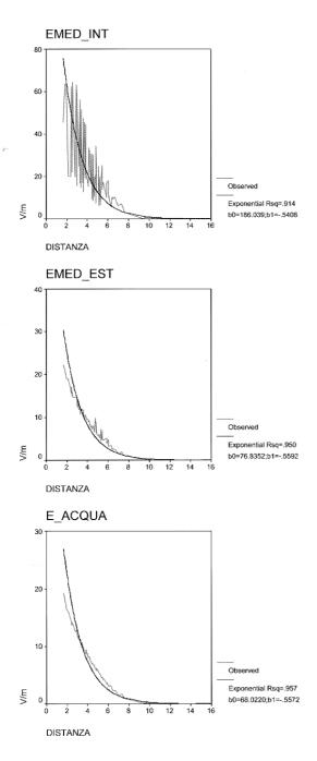
Figura 3 – Andamento del campo elettrico (V/m interno ed esterno al pesce e nell'acqua) in funzione della distanza in metri. I dati simulati seguono un modello esponenziale (p<0.01).
