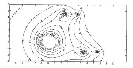
$Figura\ 2-Distribuzione\ spaziale\ delle\ linee\ equipotenziali\ (espresse\ in\ V/m)\ ottenute\ applicando\ una\ tensione\ di\ 90V,\ distanze\ in\ metri.$
